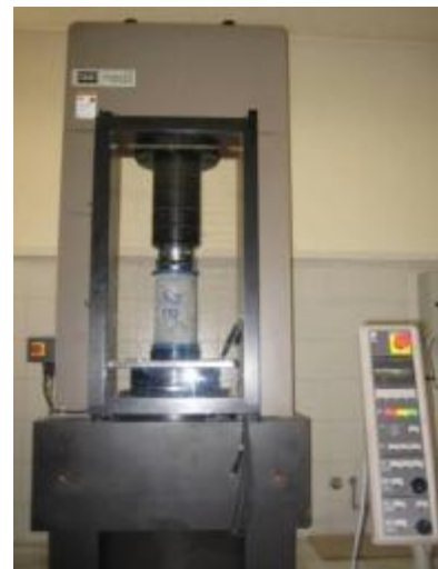
شکل ۲: آزمون بتنی تحت بارگذاری فشاری به وسیله دستگاه .MTS
