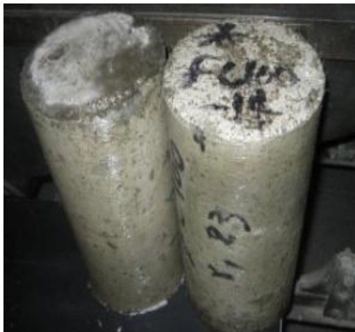
شکل ۱: آزمونه های محصور شده با الیاف GFRP.
