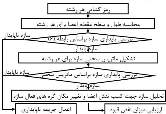
شکل ۵ بخشی از مراحل بهینه یابی مقاطع و توپولوژی خرپاها براساس GA
