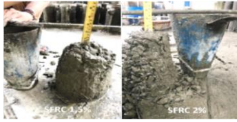
Fig 4. Slump test: a) SFRC 0%; b) SFRC 0,5%; c) SFRC 1%; d) SFRC 1,5%; and e) SFRC 2%.
