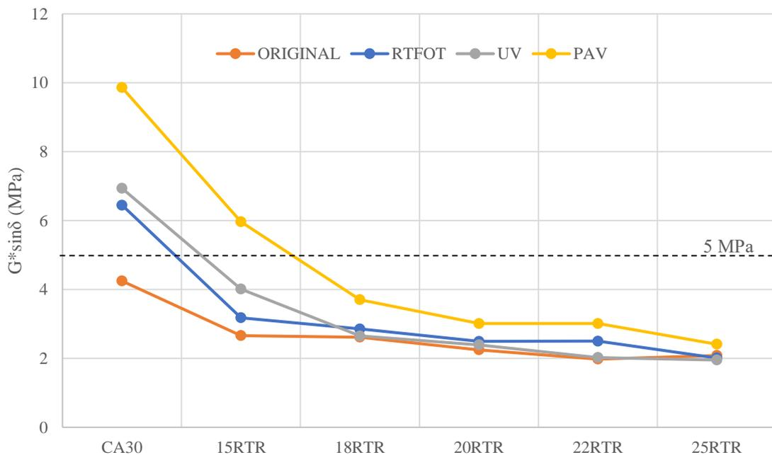
Fig. 18. SHRP SUPERPAVE  $G^*\sin\delta$  parameter at 20 °C
